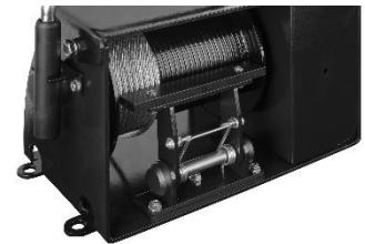
Alle Muttern der Befestigungsbolzen in gleichem Maße festdrehen und sichern.
