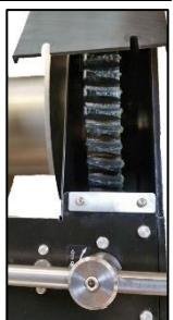
La longueur du câble doit être suffisante pour qu'il reste, lors d'une charge dans la position la plus basse, au moins 3 spires sur le tambour. La fixation du câble est effectuée au moyen du serre-câble assemblé.
