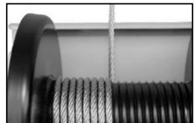
Kabellengden må være slik at minst 3 omdreininger gjenstår på trommelen når lasten er i laveste posisjon. Kabelen festes ved hjelp av de 2 innebygde kabelklemmene. Sørg for at de tre første svingene alltid forblir under kabeltrykklisten.
