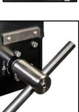
**Contrôler avant chaque utilisation si le transfert est encore assez graissé. Cela empêchera "grippage" et une surchauffe.**
