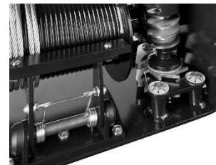
La charge nominale de la première couche de câble, indiquée sur la plaque signalétique, ne peut être dépassée. Le treuil doit être fixé à minima aux matériaux de fixation indiqués dans les tableaux 1. Le treuil doit être testé au moins une fois par an par un expert.
