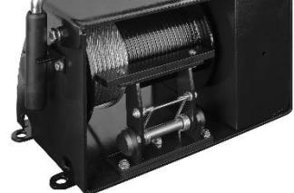
Tous les écrous des boulons de fixation doivent être vissés et verrouillés au même degré.
